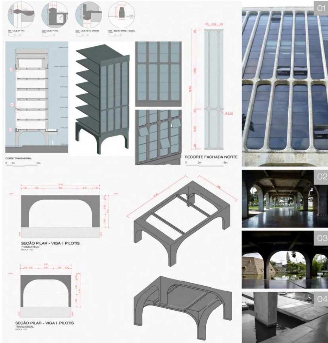
Figura 6: Corte transversal, e detalhes construtivos destacando Brises-Soleil da Fachada Norte FIEP – Federação das Indústrias da Paraíba; Imagem em detalhe Brises; Seções Pilar-Viga Pilotis Térreo FIEP; Imagens Pilotis FIEP. Fonte: Desenhos arquitetônico fornecido pelo setor de infraestrutura da FIEP (2024), modelagem e detalhes feitos pelos autores; LEITE, J. (2024); desenhos e modelagens feitos pelos autores; LEITE, J. (2024).
