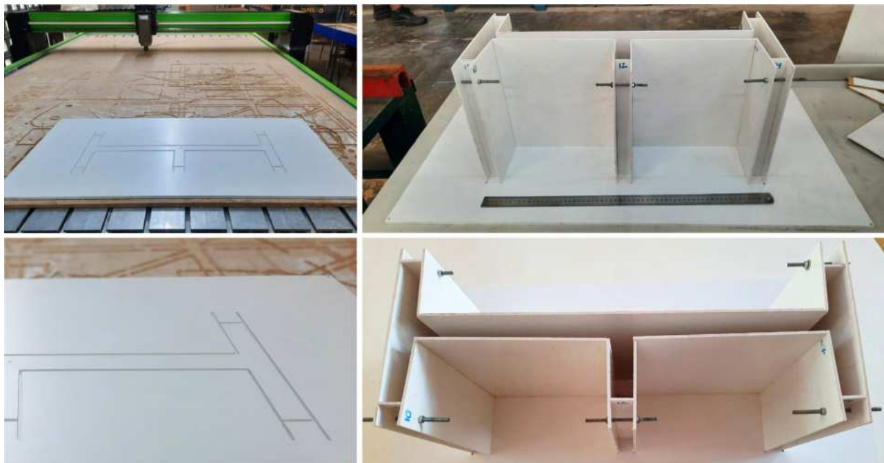
Figura 8: Perfuração da base (esquerda) e montagem de fôrma (direita) para segmento da laje de cobertura. Fonte: autor, 2024.
