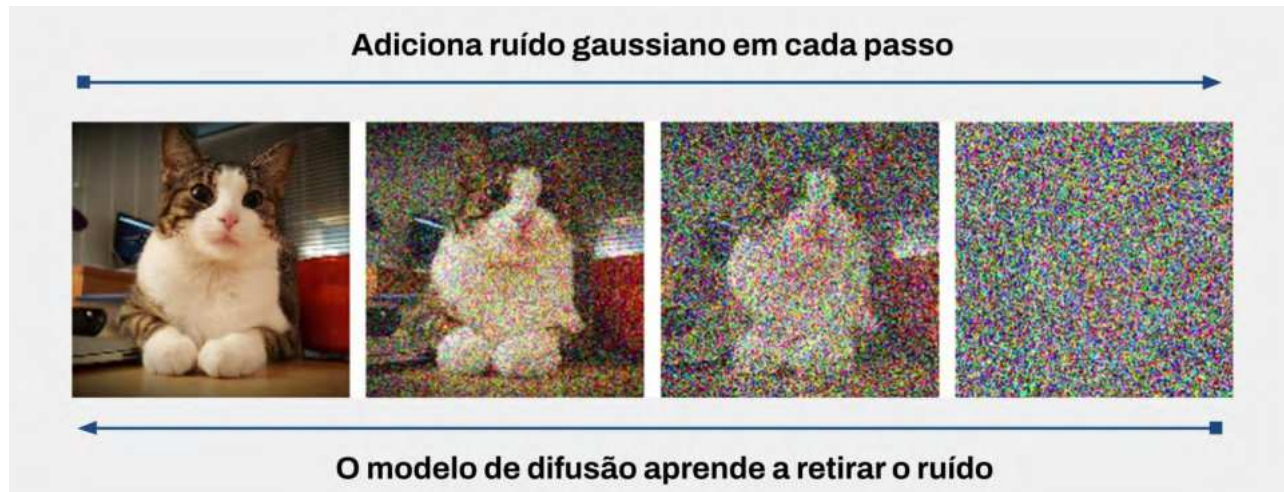
Figura 1: Processo de adição de ruído no treinamento de IAGs. Fonte: VAHDAT, A et al, 2022.
