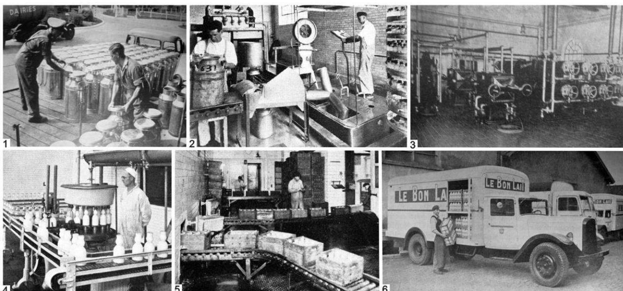
Figura 5. Processo de beneficiamento do leite. 1 Transporte das fazendas à usina em latões; 2 Recepção do leite na usina 3 Pasteurização do leite, pelo método de Stassano; 4 Acondicionamento do leite em garrafas de vidro; 5 Despacho do leite armazenado no frigorífico através de esteiras; 6 Carregamento do produto no carro para distribuição do leite aos consumidores.
