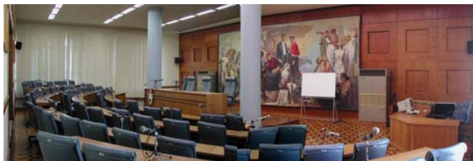
Figura 18 : Sala do Conselho, verifica-se a presença de revestimento em madeira competindo em destaque com a tela Mural das Profissões. Na mesma parede encontram-se os aparelhos de ar condicionado tipo console. O sistema de iluminação com luminária de sobrepor.
