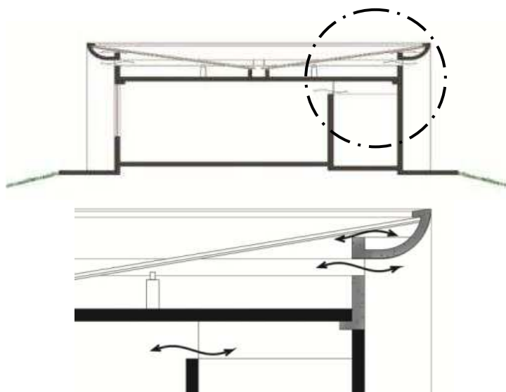
Fig. 6: Ventilação da cobertura. (Redesenho dos autores)
