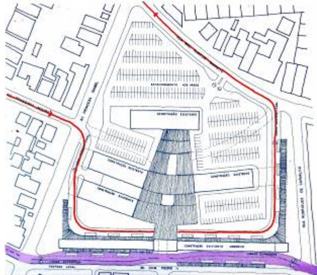
Figura 6 - O estudo de Lerner previa a demolição parcial de três dos cinco galpões para abrigar o percurso das linhas locais, em vermelho. As linhas expressas, em lilás, funcionariam em mão dupla parando na Avenida Dom Pedro II. As áreas internas ocupadas informalmente seriam destinadas a estacionamentos para servir à área central.
