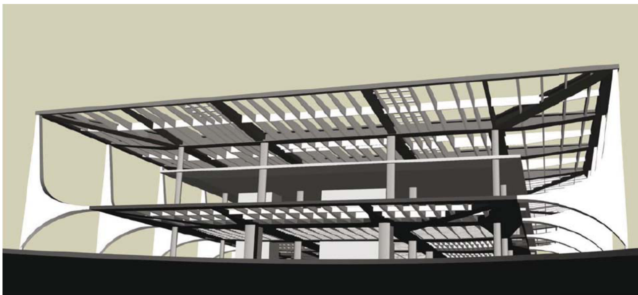
Figura 05: modelo virtual da estrutura do Palácio do Planalto. Fonte: Silva, 2012.
