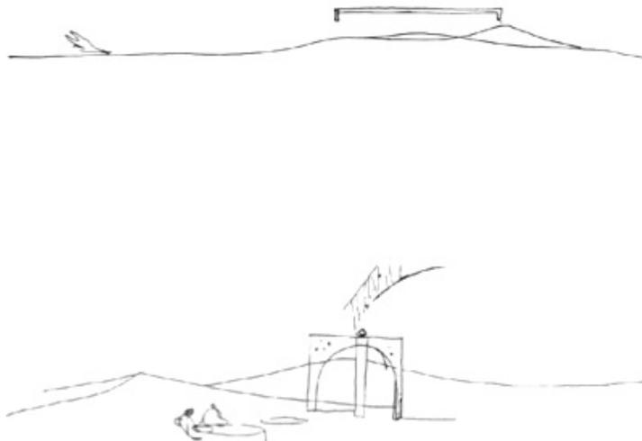
Fig 11 O croqui acima mostra a grande laje suspensa sobre o solo cuja topografia foi artificialmente criada. O tema será retomado pelo arquiteto no MubE anos mais tarde. Abaixo, uma peça coadjuvante, o expressivo pilar com quatro pontos de apoio.
