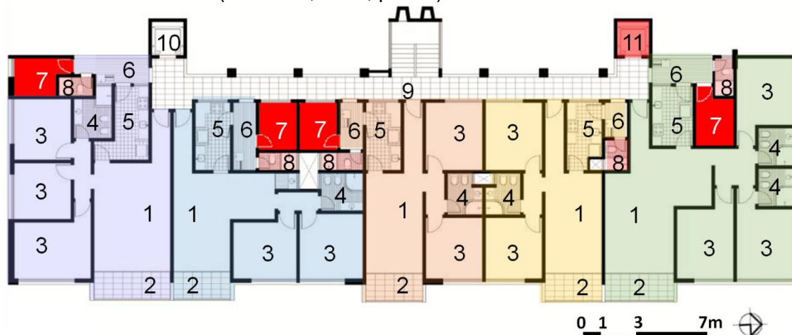
Figura 6: Planta-baixa do pavimento-tipo do edifício de apartamentos João Marques de Almeida Fonte: CHAVES, 2016, p. 323. Editado pelo autor.
